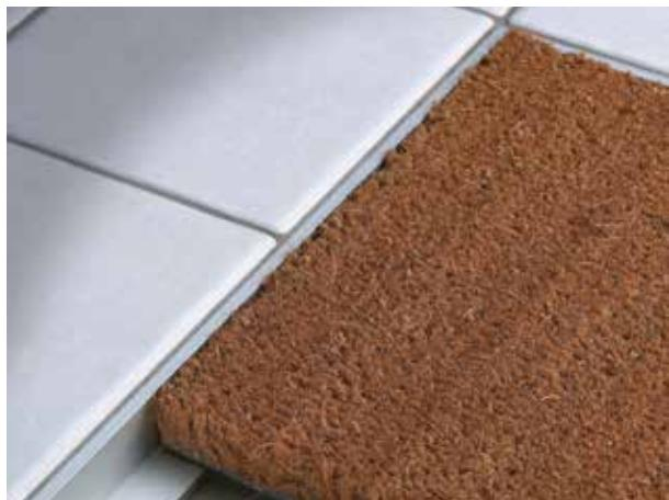
Drehbares Profil für Fußmattenrahmen aus Kokos, Teppich oder komplett aus Aluminium. Dank seiner Formgebung ist es für die Anwendung mit den üblichen Dicken von Winkelrahmen von 18 und 23 mm geeignet. Der Rahmen, welche Montage durch Dreieckgeräte erleichtert wird, muss vor dem Bodenbelag für die Verlegung positioniert werden. Das Profil kann auch mit dem variabel einsetzbaren und verschiebbaren Befestigungsanker montiert werden.
